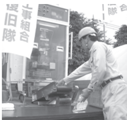
▲災害時用ウォーターサーバー(飲料水を袋詰めにする機械)
