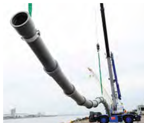
(クレーンで吊りあげても抜けない耐震管)
