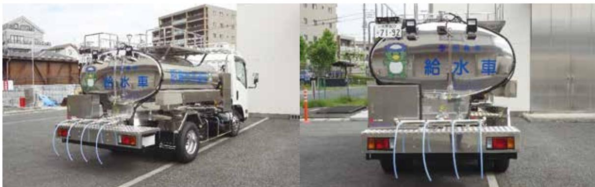
災害時に水道水の断水等が発生した際の応急給水体制を強化するため、令和6年度に応急給水対応給水車1台を新たに購入し配備しました。新しい給水車には3,000リットルの水が積み込みます。例えば、「災害発生直後に必要とされる水の量を1日1人あたり3リットル」とすると、一度に1,000人分の水を運搬できます。また、搭載する加圧ポンプにより災害時に避難所で使用する設置型組立式給水タンク等への直接注水が可能です。
