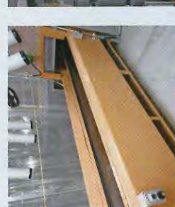
①不燃ごみ手選別コンベヤ 人の手によって、袋、不燃物、不燃ごみを分けられます。
