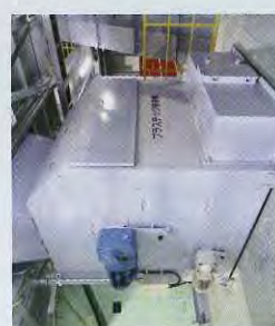
⑫プラスチック破砕機 収集袋を破り、プラスチック手選別コンベヤへ送ります。
