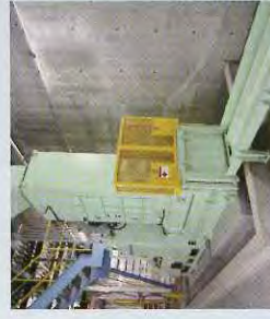
⑩アルミ缶圧縮成型機 回収されたアルミ缶類を圧縮成型します。
