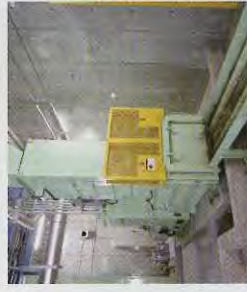
⑨鉄缶圧縮成型機 回収され鉄缶類を圧縮成型します。
