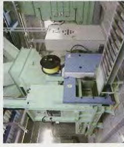
8 ペットボトル圧縮梱包機 回収されたペットボトルを圧縮梱包します。
