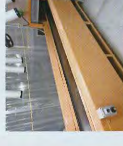
1 不燃ごみ手選別コンベヤ 人の手によって、袋、不燃ごみを分けられます。
