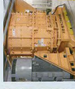
②不燃粗大ごみ破砕機 不燃ごみ、袋、不燃ごみを細かく破砕します。
