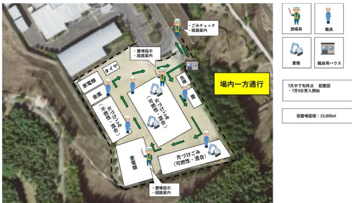
図 3-4-2 仮置場のレイアウト及び搬入ルート（風水害災害発生時の設置例）
