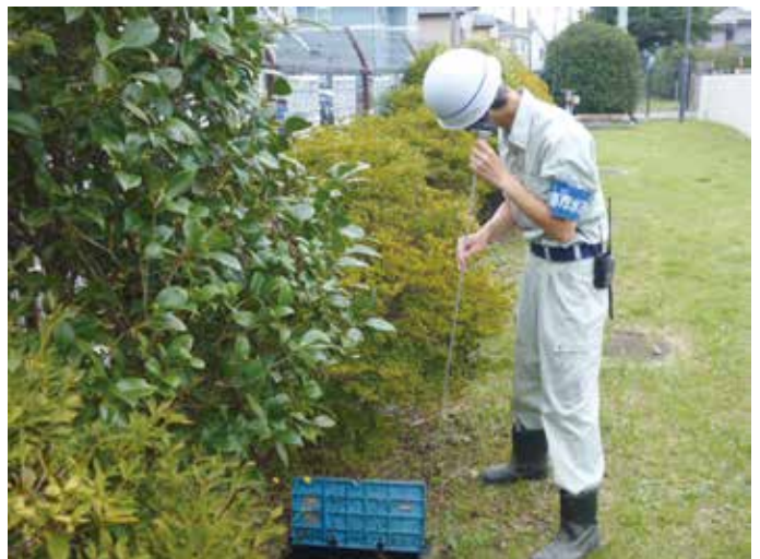
漏水調査の様子
